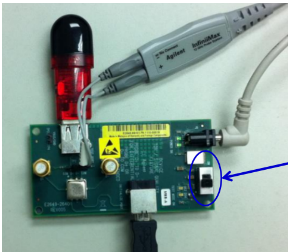
图 5 Agilent USB 2.0 SQ 测试夹具连接方法
