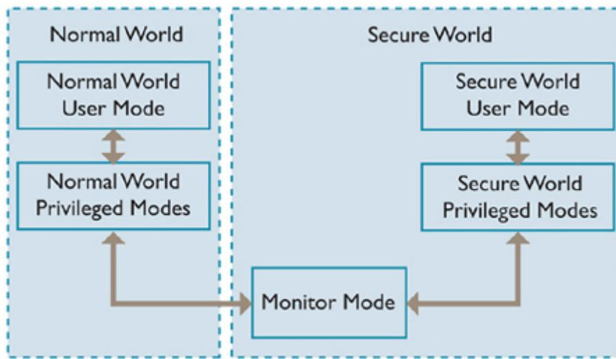
可通过以下方式确保系统安全：隔离所有SoC硬件和软件资源，使它们分别位于两个区域（用于安全子系统的安全区域以及用于存储其他所有内容的普通区域）中。支持TrustZone的AMBA3 AXI™总线构造中的硬件逻辑可确保普通区域组件无法访问安全区域资源，从而在这两个区域之间构建强大边界。将敏感资源放入安全区域的设计，以及在安全的处理器内核中可靠运行软件可确保资产能够抵御众多潜在攻击，包括那些通常难以防护的攻击（例如，使用键盘或触摸屏输入密码）。通过在硬件中隔离安全敏感的外设，设计人员可限制需要通过安全评估的子系统的数目，从而在提交安全认证设备时节省成本。
