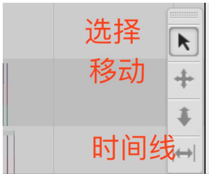
先用“时间线”模式拉个 1s 左右的时间线，然后切到“选择”模式，选择这段时间线内 render 线程的区域，会自动在下方列出这个区域的函数统计：
